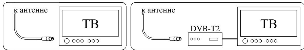
Для антенн моделей Эфир-18AF и Эфир-18 AF TURBO после подключения кабеля к телевизору или цифровой приставке (схемы подключения аналогичны схемам 1 и 2), следует включить подачу питания +5В на цифровую антенну от телевизора или цифровой приставки.
