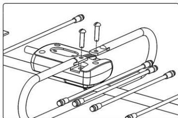
**1** Установить петлевой вибратор вставив его плоские концы в пазы монтажной коробки и закрепить винтами.
