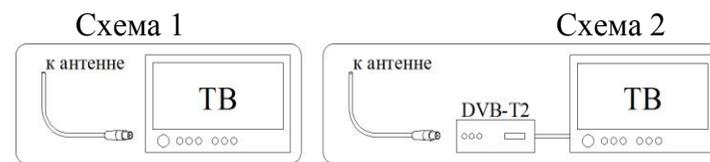
После подключения кабеля к телевизору (см. схему 1) или цифровой приставке (см. схему 2), следует включить подачу питания +5В на цифровую антенну от телевизора или цифровой приставки. подача питания +5В включается согласно руководству по эксплуатации телевизора или цифровой приставки DVB-T2.
