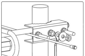
**2** Установить антенну на кронштейн или мачту. Присоединить провод заземления к узлу крепления антенны.
