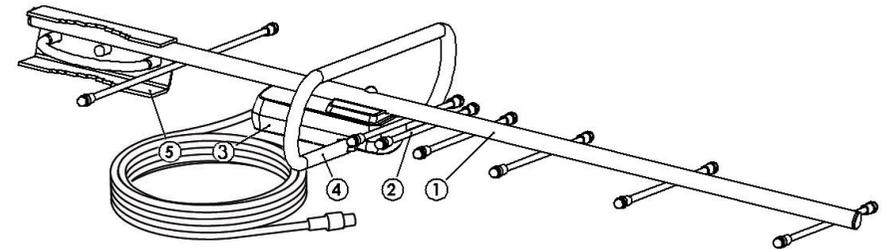
Антенна представляет собой несущую штангу (1), на которой закреплены директоры (2), монтажная коробка (3) с петлевым вибратором (4) (установку производит потребитель см. п.5), усилитель с вмонтированным кабелем. Для установки на мачту антенна имеет узел крепления (5).
