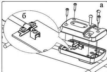
2 (а) Снять крышку монтажной коробки, отвернув самонарезающие винты и винты крепления петлевого вибратора.
