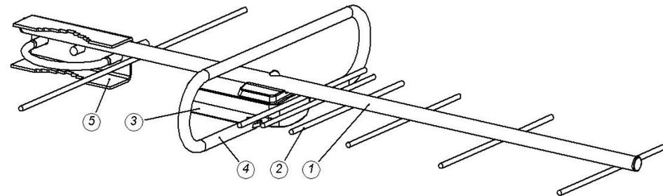
Антенна представляет собой несущую штангу (1), на которой закреплены директор (2), монтажная коробка (3), петлевым вибратором (4) (установку производит потребитель см. п.5). Для установки на мачту антенна имеет узел крепления (5).
