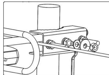
4 Установить антенну на мачте и присоединить провод заземления к узлу крепления антенны. Ориентировать антенну на телецентр по наилучшему качеству изображения на экране телевизора. Окончательно зафиксировать антенну.
