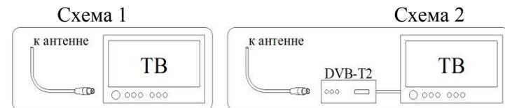
После подключения кабеля к телевизору (см. схему 1) или цифровой приставке (см. схему 2), следует включить подачу питания +5В на цифровую антенну от телевизора или цифровой приставки. Подача питания +5В включается согласно руководству по эксплуатации телевизора или цифровой приставки DVB-T2.
