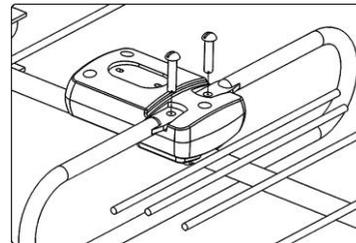
3 Установить петлевой вибратор вставив его плоские концы в пазы монтажной коробки и закрепить винтами.
