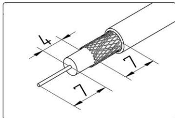
1 Для крепления антенного кабеля к плате необходимо **разделить один конец кабеля согласно рисунку**. Отмерить антенный кабель необходимой длины. На другой конец установить антенную вилку, разделив кабель в зависимости от способа ее крепления.
